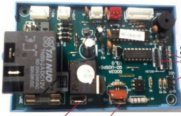
SWING MOTOR 12V CC Conexión de Swing Terminal Grande o Terminal Chico
