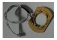
El sensor Hall proveerá la plaqueta universal la señal adecuada para indicar que el motor está girando la velocidad seleccionada por el usuario, con el control remoto.
