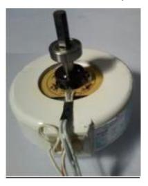
Si el sensor Hall está mal conectado, o falló. La placa interpreta el error y detiene el equipo.
